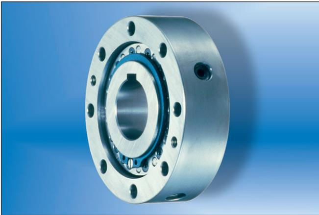
Die Freilaufbaureihe BR ist für die fliehkräftabhebende Bewegung konstruiert. Zwischen Innen- und Außenring besteht während des Betriebes kein mechanischer Kontakt. Durch Zentrifugalkräfte werden die speziell geformten Nocken abgehoben. Diese Baureihe ist auch als Lift-off-Type bekannt. Speziellere Informationen auf Anfrage.
