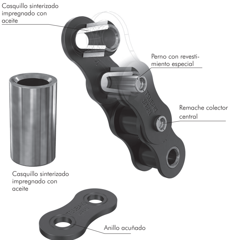
Fig. 10 Construcción básica
