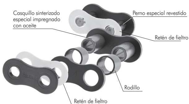
Fig. 11 Construcción básica
